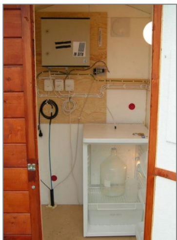
Figur 4. Utrustning för flödesproportionell provtagning i typområde I28.
